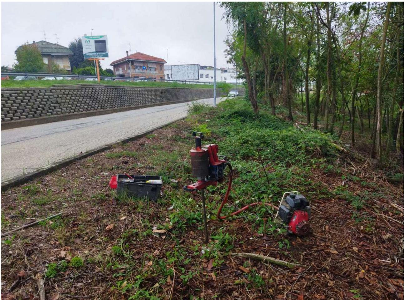
**Figura 4:** immagine fotografica della realizzazione della prova DPM-02.
