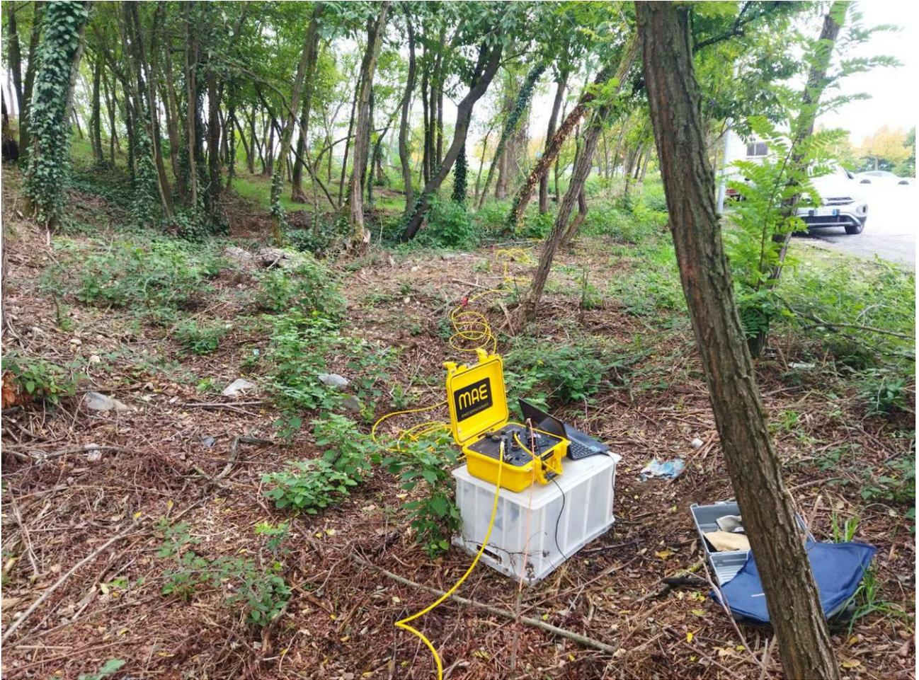
**Figura 6:** immagine fotografica dello stendimento sismico eseguito in sito.
